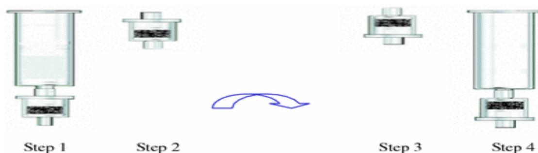
500mg/3cc PSA 固相萃取柱置于石墨碳黑可颠倒固相萃取柱的上方。GCB/PSA (或 aminopropyl) 双层固相萃取柱中石墨碳黑 500mg, 太多。在可颠倒固相萃取柱加 200mg 石墨碳黑已足够。用 5 毫升乙腈冲洗平衡，然后 5mL 萃取液上样，最后用 12 毫升乙腈冲洗回收所有的检测化合物例如残留农药(pesticides)。丢弃 PSA 固相萃取柱。将石墨碳黑固相萃取柱翻转。Thiabendazole, coumaphos, cyprodinil 和 chlorothalonil 等留在柱头，翻转后用 8 毫升乙腈：甲苯(3:1) 冲洗回收(参考文献 17)。
